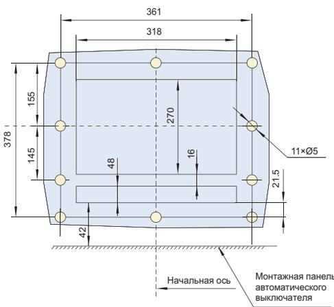
**Выключатель выкатного исполнения NA8-7500 ( $I_n=4000\div5000A$ ), 4-полюсный, заднее горизонтальное присоединение**
