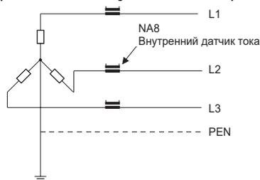
Четырехполюсный автоматический выключатель обеспечивает защиту от замыкания на землю путем определения векторной суммы токов трех фаз и нейтрали, измеряемых четырьмя встроенными трансформаторами тока, и сравнения ее с уставкой настроенной на электронном расцепителе.
