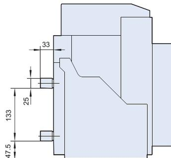
**Примечание:** при необходимости изменить горизонтальное подключение на вертикальное на месте установки выключателя достаточно повернуть присоединения на 90°.
