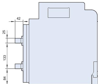
**Примечание:** при необходимости изменить горизонтальное подключение на вертикальное на месте установки выключателя необходимо заменить верхние и нижние присоединения полюсов N и В на такие же как А и С.
