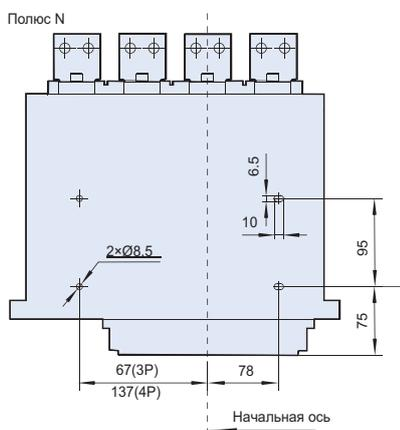
Размеры отверстий в передней панели щита
