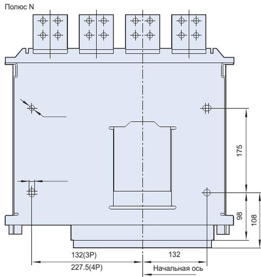
Размеры отверстий в передней панели щита
