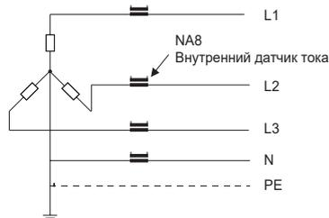
Система 3P+N обеспечивает защиту от замыкания на землю путем определения векторной суммы токов трех фаз, измеряемых тремя встроенными трансформаторами тока, и внешнего трансформатора тока нейтрали.
