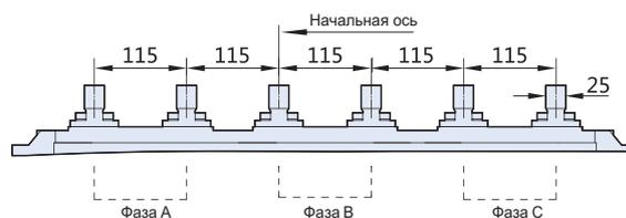
**Примечание:** для  $I_n=6300A$  возможно только вертикальное подключение, а горизонтальное подключение недоступно.
