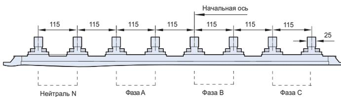
**Выключатель выкатного исполнения NA8-7500 ( $I_n=6300A$ ), 4-полюсный, заднее горизонтальное присоединение**
