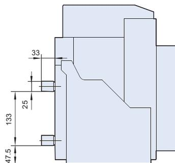
**Примечание:** при необходимости изменить горизонтальное подключение на вертикальное на месте установки выключателя необходимо заменить верхние и нижние присоединения полюсов N и В на такие же как А и С.
