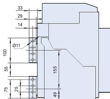
**Примечание:** при необходимости изменить горизонтальное подключение на вертикальное на месте установки выключателя необходимо заменить верхние и нижние присоединения полюсов N и В на такие же как А и С.
