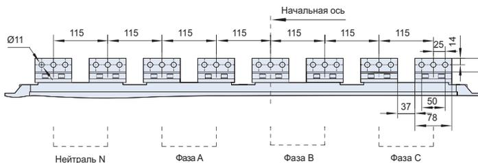
**Выключатель выкатного исполнения NA8-7500 ( $I_n=4000\div5000A$ ), 4-полюсный, заднее вертикальное присоединение**
