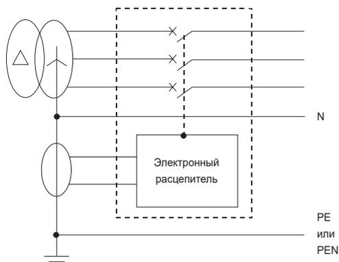
В этом случае внешний трансформатор тока позволяет обнаружить возникновение замыкания на землю как на стороне источника питания автоматического выключателя, так и на стороне нагрузки.
