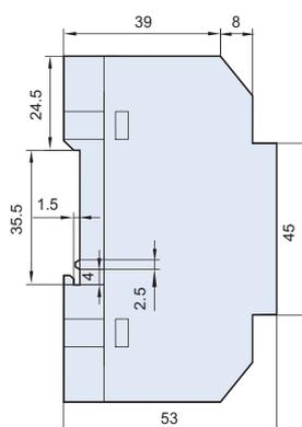
**Примечание:** модуль выдержки времени расцепителя минимального напряжения, модуль питания и модуль сигналов RU-1 имеют одинаковые габаритные размеры и устанавливаются на DIN-рейку 35 мм.
