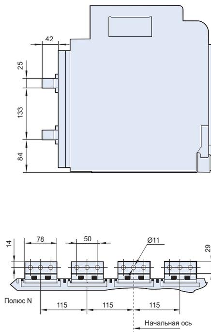
**Выключатель выкатного исполнения NA8-2500 ( $I_n=1600\div 2500A$ ), заднее вертикальное присоединение**
