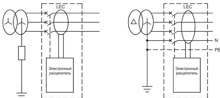
Для реализации функции дифференциальной защиты автоматический выключатель серии NA8 должен соответствовать следующим требованиям:
