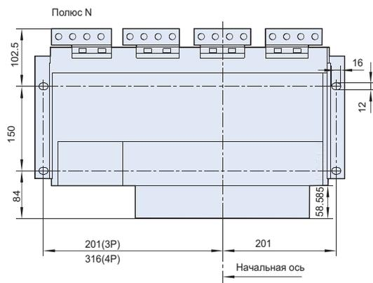
Размеры отверстий в передней панели щита
