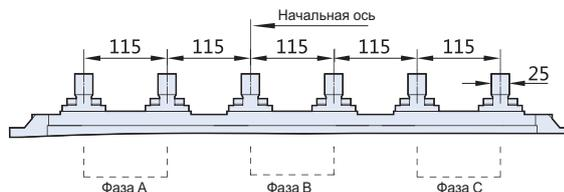
**Примечание:** при необходимости изменить вертикальное подключение на горизонтальное на месте установки выключателя достаточно повернуть присоединения на 90°.
