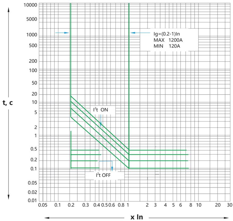
Рис. 2. Характеристики защиты от замыкания на землю
