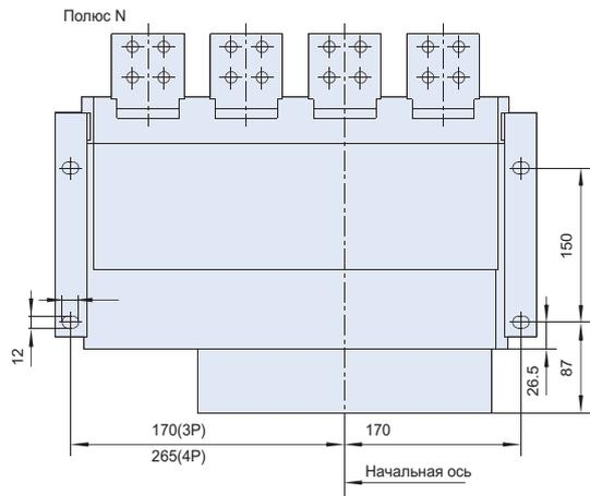
Размеры отверстий в передней панели щита
