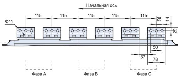
**Примечание:** при необходимости изменить горизонтальное подключение на вертикальное на месте установки выключателя достаточно повернуть присоединения на 90°.
