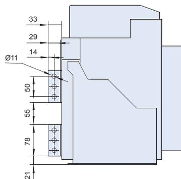
**Примечание:** при необходимости изменить вертикальное подключение на горизонтальное на месте установки выключателя достаточно повернуть присоединения на 90°.
