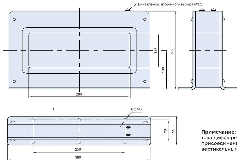
**Примечание:** для установки трансформатора тока дифференциальной защиты (LEC) нижние присоединения выключателя должны быть вертикальными.
