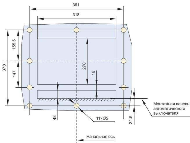
**Выключатель выкатного исполнения NA8-2500 ( $I_n=1600\div 2500A$ ), заднее горизонтальное присоединение**
